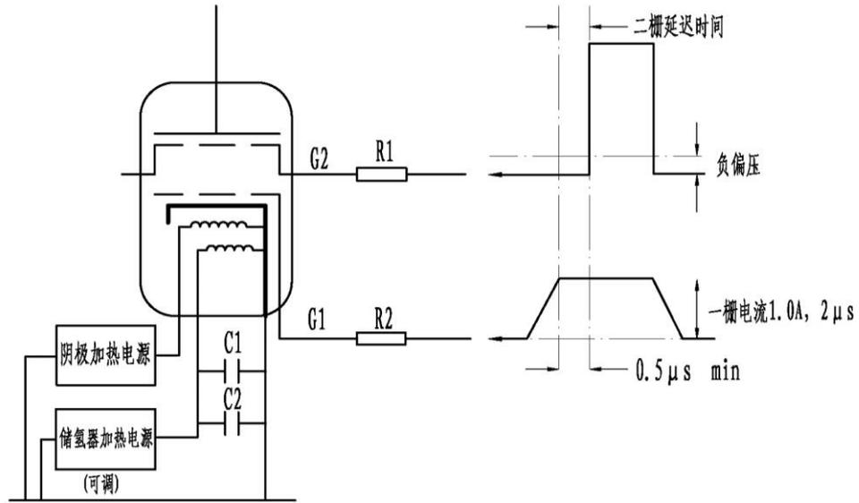
R1, 一栅串联电阻, 12W 玻璃釉瓷线绕电阻, 其阻抗与触发电路相匹配;
